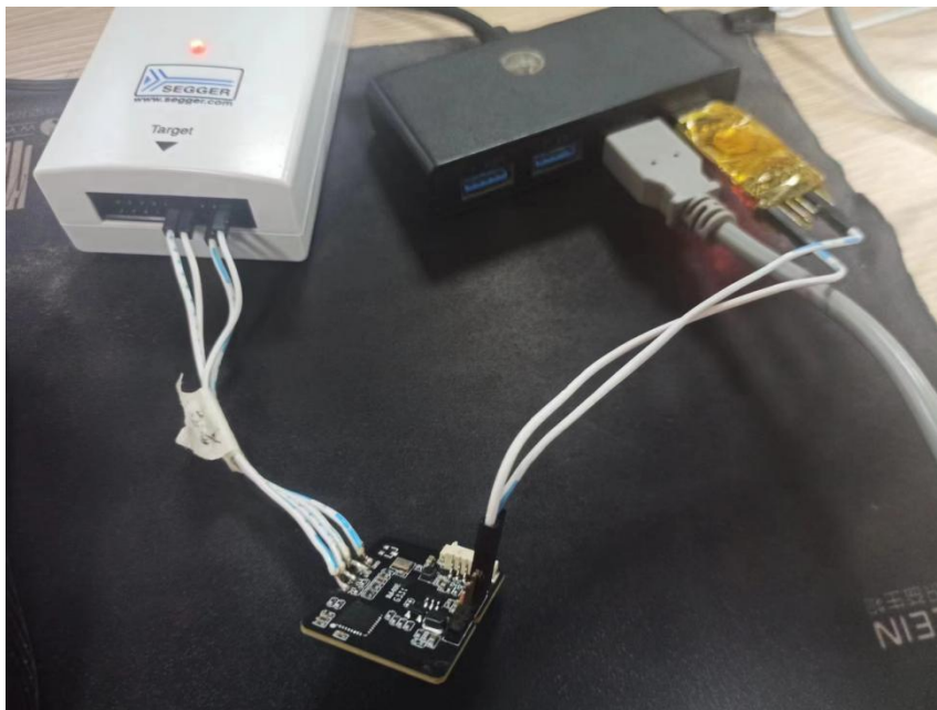
图 1.2 J-Link 烧录接线
