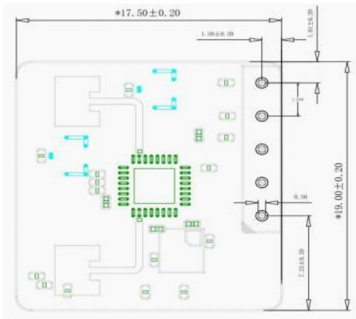
图 9 推荐 PCB 封装尺寸
