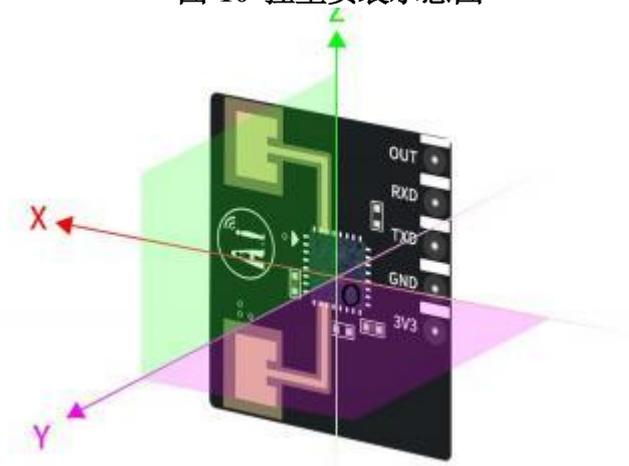
图 11 挂壁方向示意图
