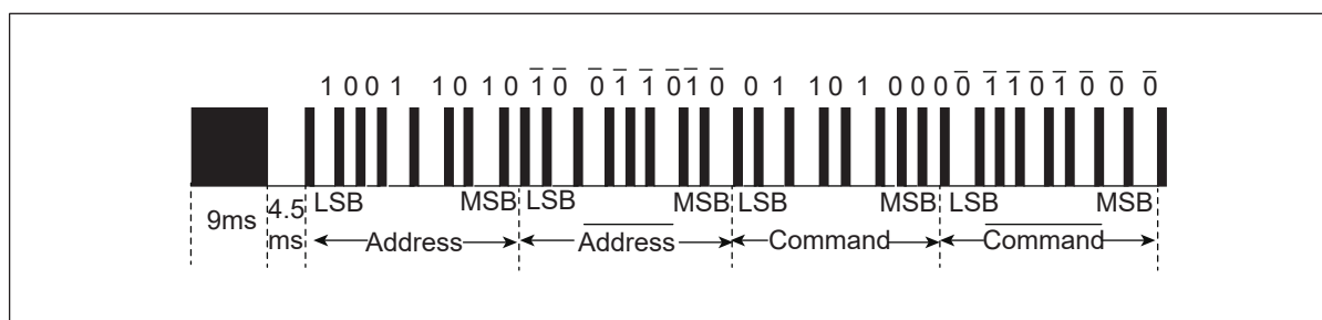
图 8.2: NEC 协议波形
