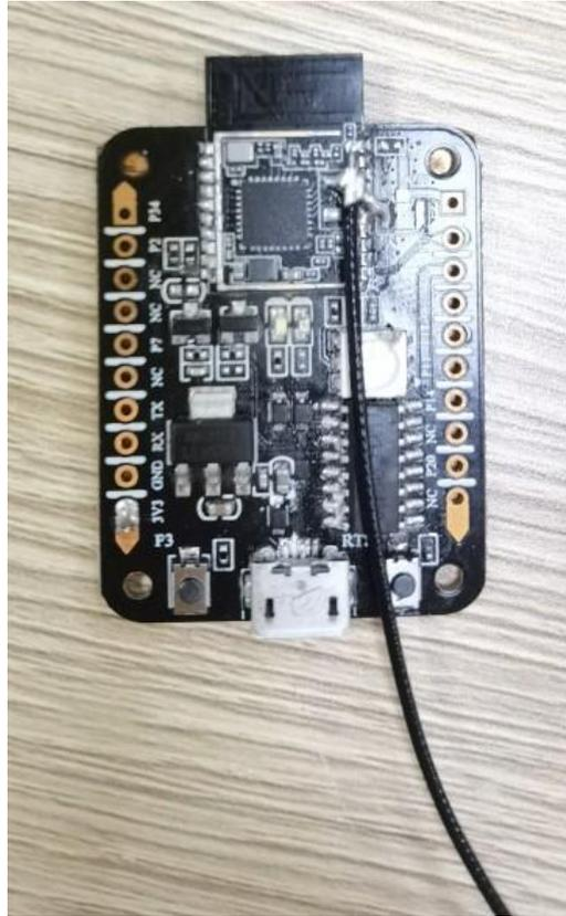
图 7 天线测试样机示意图
