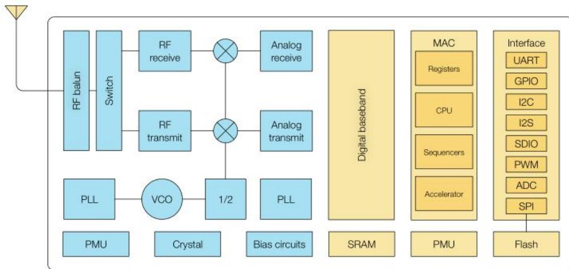
ESP8266 拥有完整的且自成体系的 Wi-Fi 网络功能，既能够独立应用，也可以作为从机搭载于其他主机 MCU 运行。当 ESP8266 独立应用时，能够直接从外接 flash 中启动。内置的高速缓冲存储器有利于提高系统性能，并且优化存储系统。
