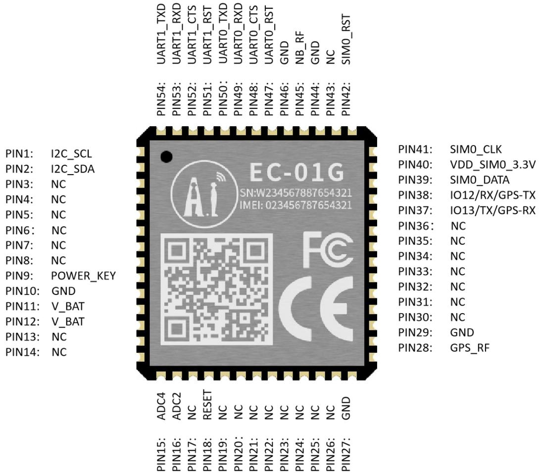
图 6 EC-01G 管脚示意图(图片及丝印仅供参考，以实物为准)
