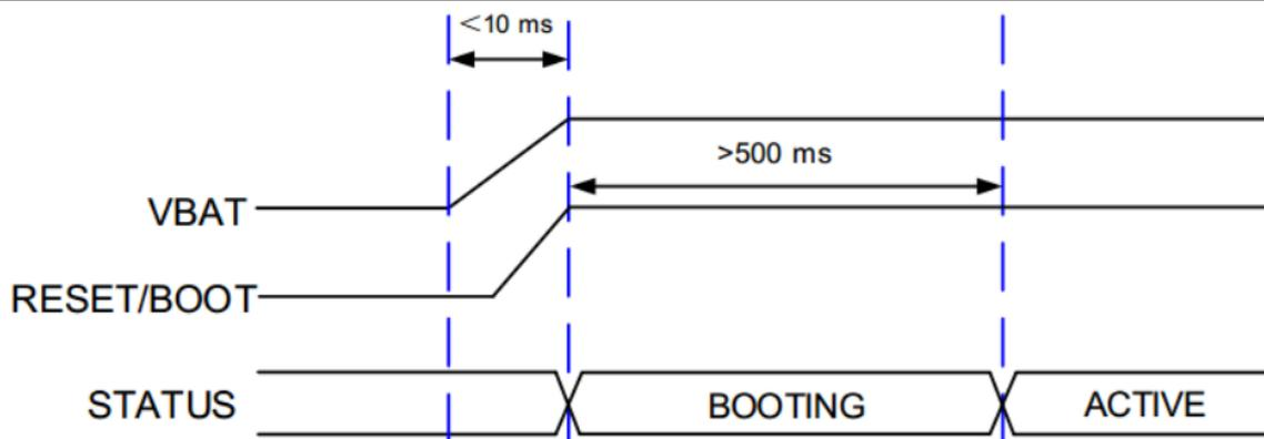
图 11 NB 芯片上电时序图
