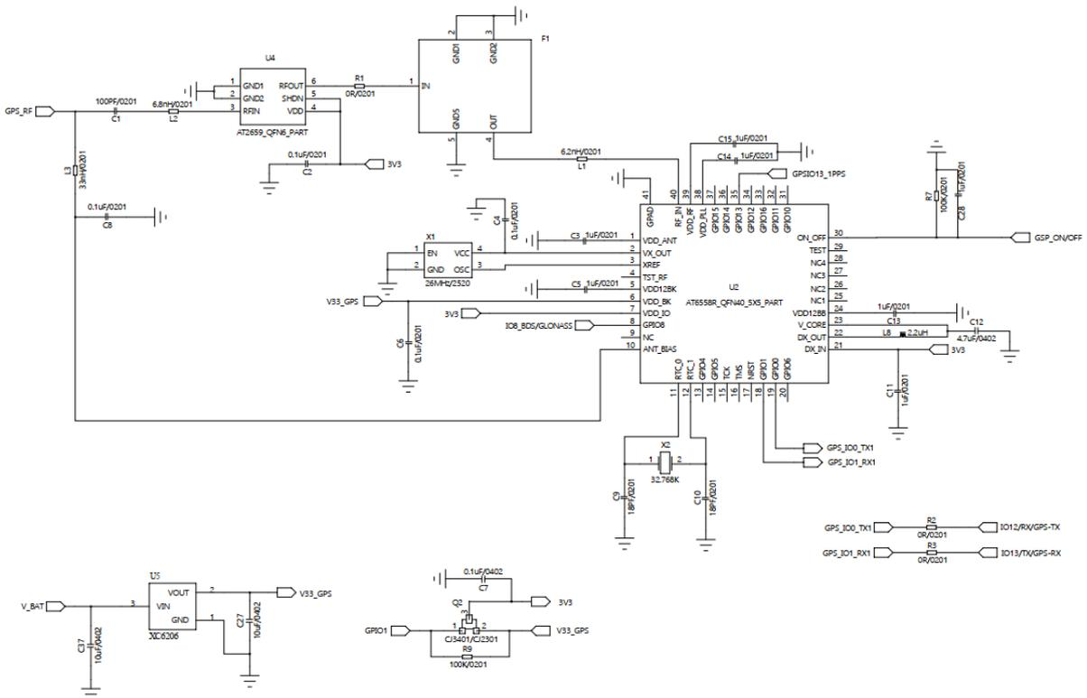
图 8 模组原理图 GPS 部分
