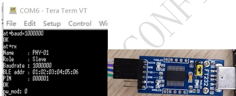
2. 更新波特率后，设置连接间隔(`at+cint=6,8`，跟手机 APP 握手后，实际 connect interval 为 11.25ms)，使能 DMA 模式，设置块大小(`at+div=256`)，和传输方向；
