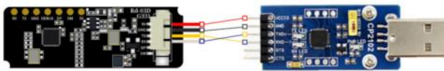
图 1.1 Rd-03D_V2 模组通过右侧排针与串口工具连接
