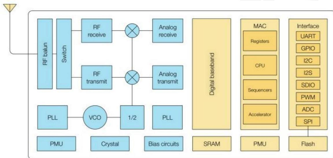
ESP8285 是一个完整且自成体系的 WiFi 网络解决方案,能够独立运行,也可以作为从机搭载于其他主机 MCU 运行。ESP8285 在搭载应用并作为设备中唯一的应用处理器时,能够直接从外接闪存中启动。内置的高速缓冲存储器有利于提高系统性能,并减少内存需求。
