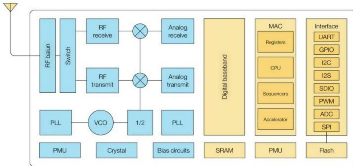
ESP8266 是一个完整且自成体系的 WiFi 网络解决方案，能够独立运行，也可以作为从机搭载于其他主机 MCU 运行。ESP8266 在搭载应用并作为设备中唯一的应用处理器时，能够直接从外接闪存中启动。内置的高速缓冲存储器有利于提高系统性能，并减少内存需求。
